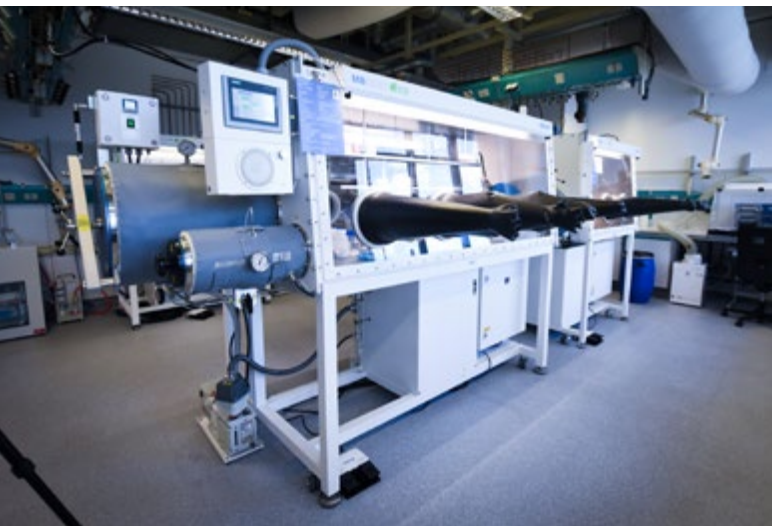
Glovebox-Anlagen der Bianchini Gruppe zur Assemblierung von Li-Ionen und Na-Ionen Batterien.
