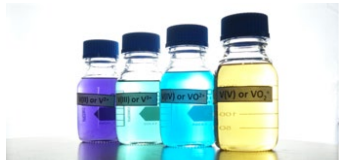
Elektrolyt für Redox-Flow-Batterien auf Basis von Vanadium in verschiedenen Oxidationsstufen.
